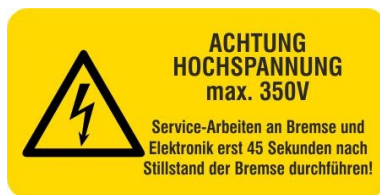
Фиг.6: Предупредителна бележка върху спирачката поради опасност от високо напрежение.
