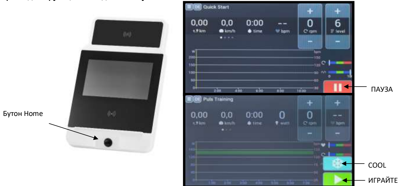
Фиг. 2: Изглед на монитора, за да се обяснят функциите на бутоните, действителният изглед може да се различава по цвят, но предназначението на бутоните е същото.
