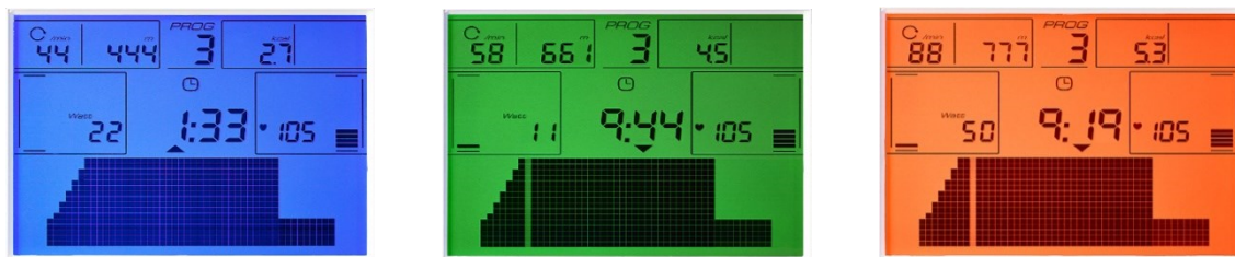
Фиг.4: Многоцветна подсветка като биологична обратна връзка за индикация на съответствие с целта.
