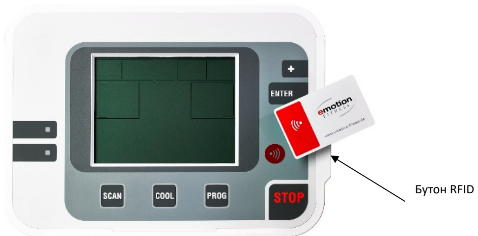
Фиг.5: Бутон RFID, за откриване на RFID, ако носителят не може или не трябва да бъде поставен.
