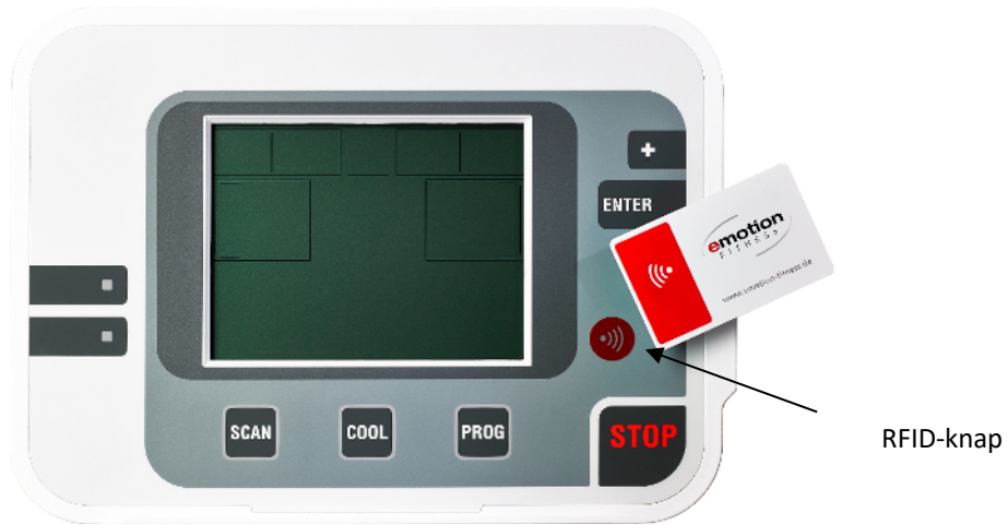
Fig.5: RFID-knap, til RFID-detektion, hvis der ikke kan eller må indsættes et medium
