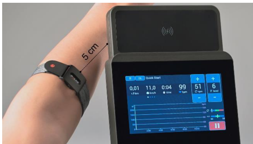
Fig.: Parring af en ANT+-sensor til pulstransmission
