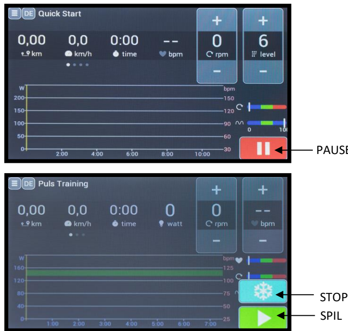
Fig. 2: Monitorvisning, for at forklare knapfunktionerne, den faktiske visning kan variere i farve, knaptildelingen er den samme.
