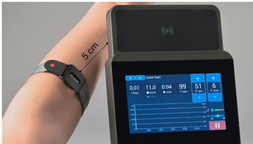
Abb. 11: Pairing eines ANT+ Sensors zur Herzfrequenzübertragung
