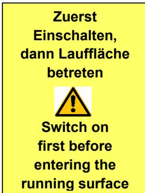
Der Sicherheitshinweis zum Betreten der Lauffläche befindet sich oberhalb des Einschaltknopfes, hinten rechts am LB-rahmen.
