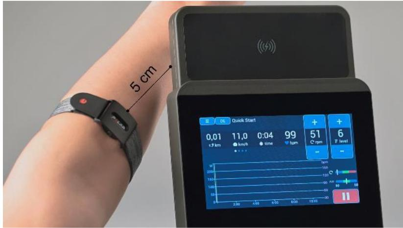
Abb. 11: Pairing eines ANT+ Sensors zur Herzfrequenzübertragung
