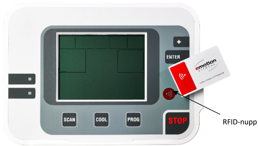
Joonis 5: RFID-nupp, RFID tuvastamiseks, kui andmekandjat ei saa või ei tohi sisestada.
