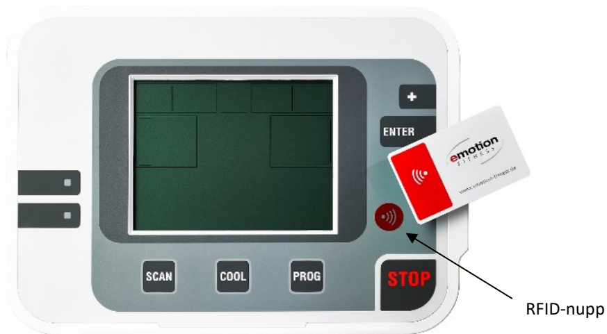
Joonis 5: RFID-nupp, RFID tuvastamiseks, kui andmekandjat ei saa või ei tohi sisestada.
