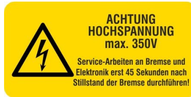
Joonis 6: Hoiatusmärkus piduril kõrgepingeohu tõttu.
