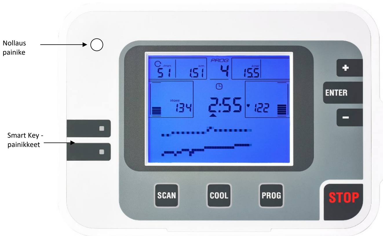
Kuva 2: Näytön näkymä edestäpäin, jossa selitetään painikkeiden toiminnot.
