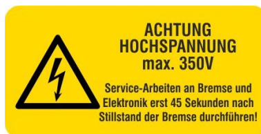
Kuva 6: Jarrussa oleva varoitus korkeajännitteen aiheuttaman vaaran vuoksi.
