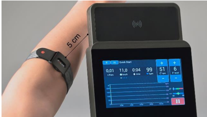
Kuva 11: ANT+-anturin pariliitoksen muodostaminen sykkeen lähettämistä varten.
