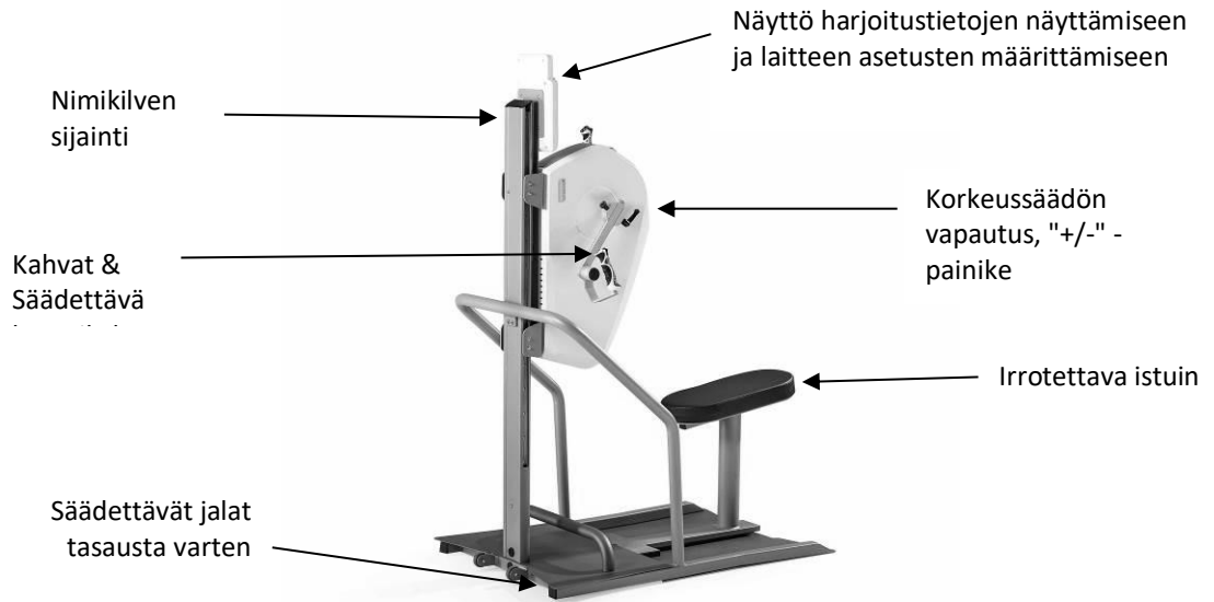
Kuva 3: Laitteen näkymä motion body 900 ja motion body900 med sekä pääelementtien ja sovellusosien nimitykset.
