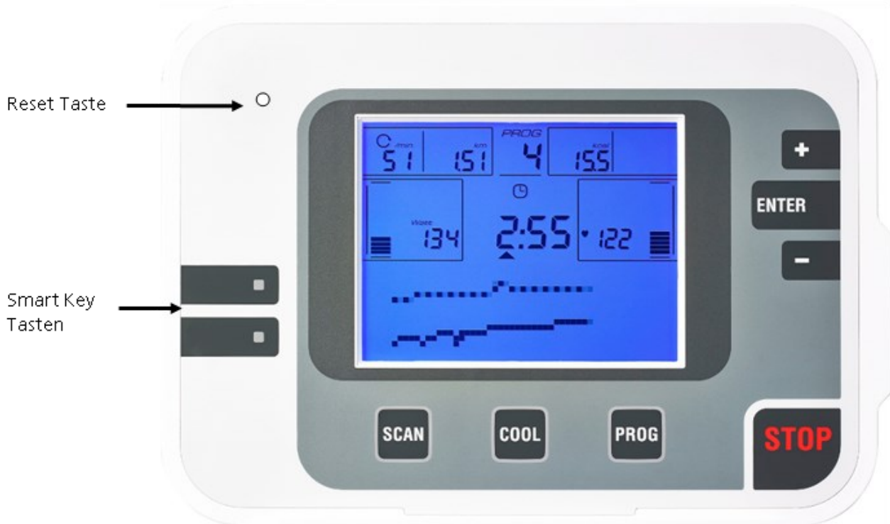
Kuva 2: Näytön näkymä edestäpäin, jossa selitetään painikkeiden toiminnot.
