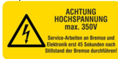
Kuva 6: Jarrussa oleva varoitus korkeajännitteen aiheuttaman vaaran vuoksi.
