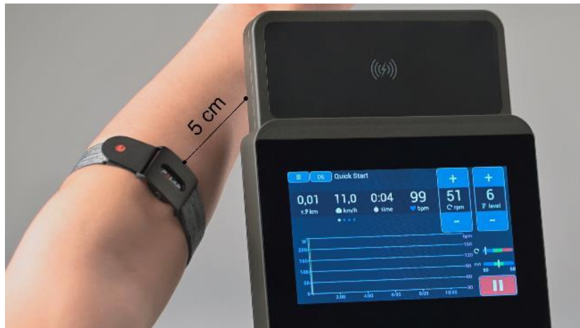
Kuva: ANT+-anturin pariliitoksen muodostaminen sykkeen lähettämistä varten.
