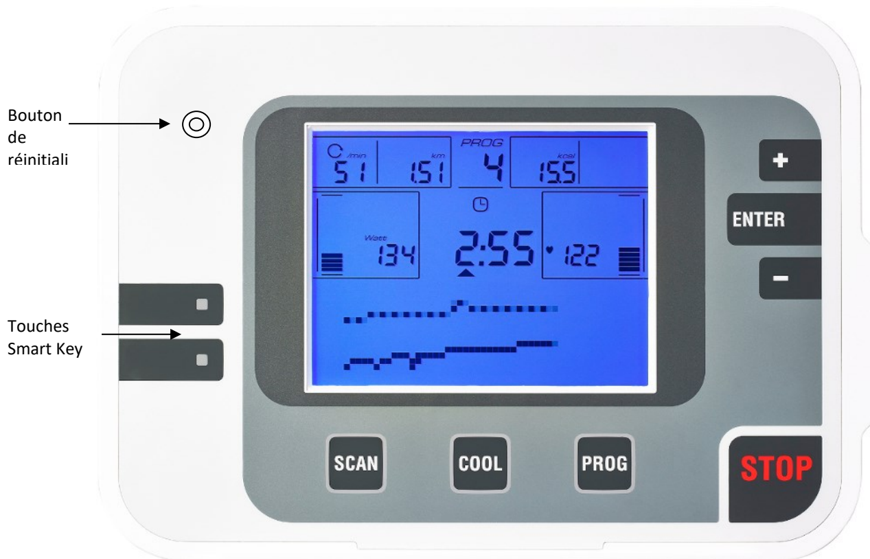
Figure 2 : Vue frontale du moniteur, pour expliquer les fonctions des touches
