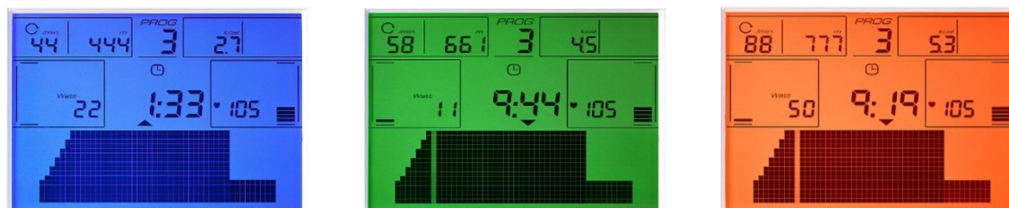
Fig.4 : Rétroéclairage multicolore comme biofeedback pour indiquer le respect des objectifs.
