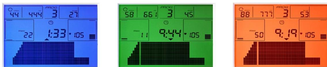
Fig.4 : Rétroéclairage multicolore comme biofeedback pour indiquer le respect des objectifs.
