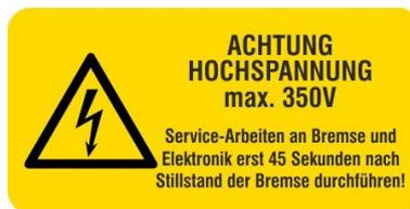
Fig.6 : Avertissement sur le frein en raison d'un risque de haute tension.
