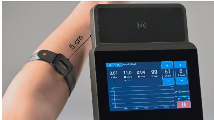
Figura: Accoppiamento di un sensore ANT+ per la trasmissione della frequenza cardiaca
