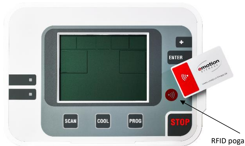
5. attēls: RFID poga RFID noteikšanai, ja nesēju nevar vai nedrīkst ievietot.
