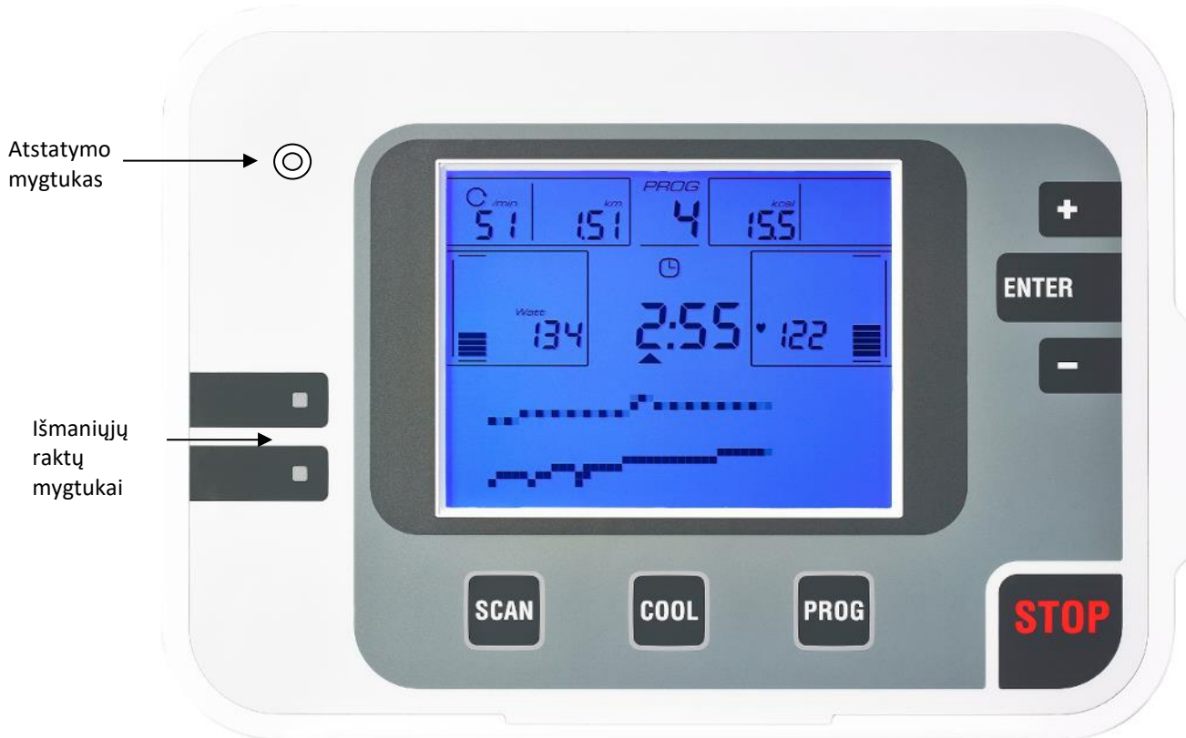
2 pav. 2. Monitoriaus vaizdas iš priekio, paaiškinantis mygtukų funkcijas
