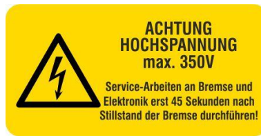
6 pav.: Įspėjamasis užrašas ant stabdžių dėl aukštos įtampos pavojaus.
