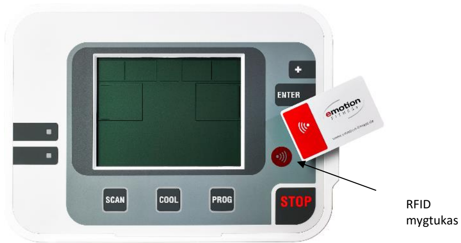
5 pav.: RFID mygtukas, skirtas RFID aptikti, jei laikmenos negalima arba nevalia įdėti.
