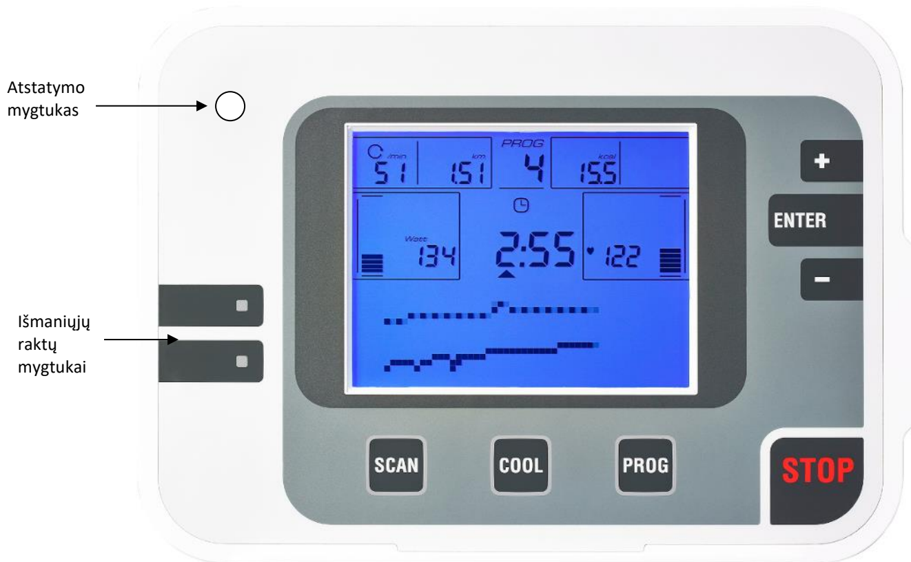
2 pav. 2. Monitoriaus vaizdas iš priekio, paaiškinantis mygtukų funkcijas
