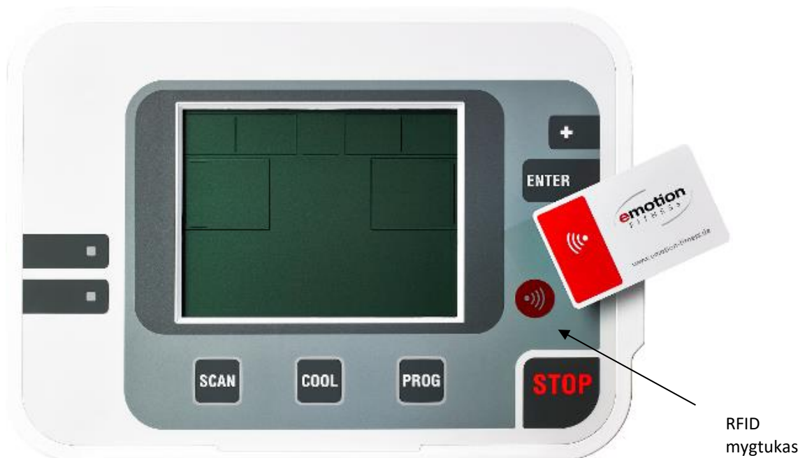
5 pav.: RFID mygtukas, skirtas RFID aptikti, jei laikmenos negalima arba nevalia įdėti.
