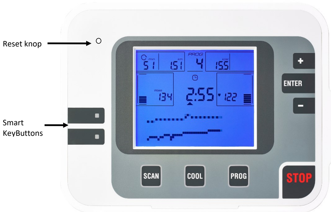
Figuur 2: Monitor vooraanzicht, met uitleg van de knopfuncties
