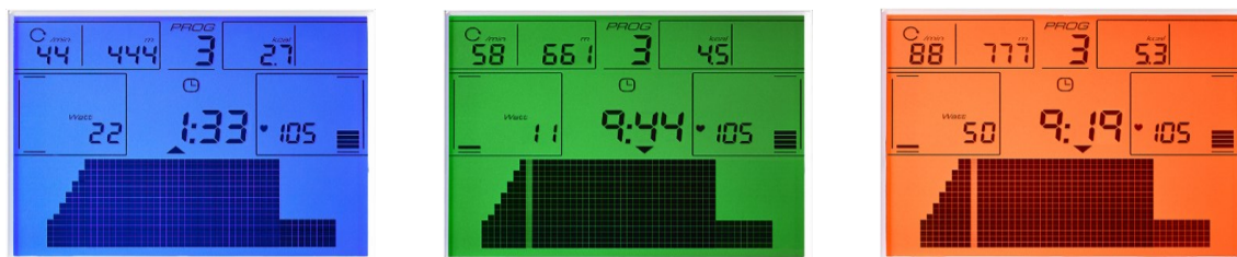
Fig.4: Veelkleurige achtergrondverlichting als biofeedback om aan te geven of het doel is bereikt.
