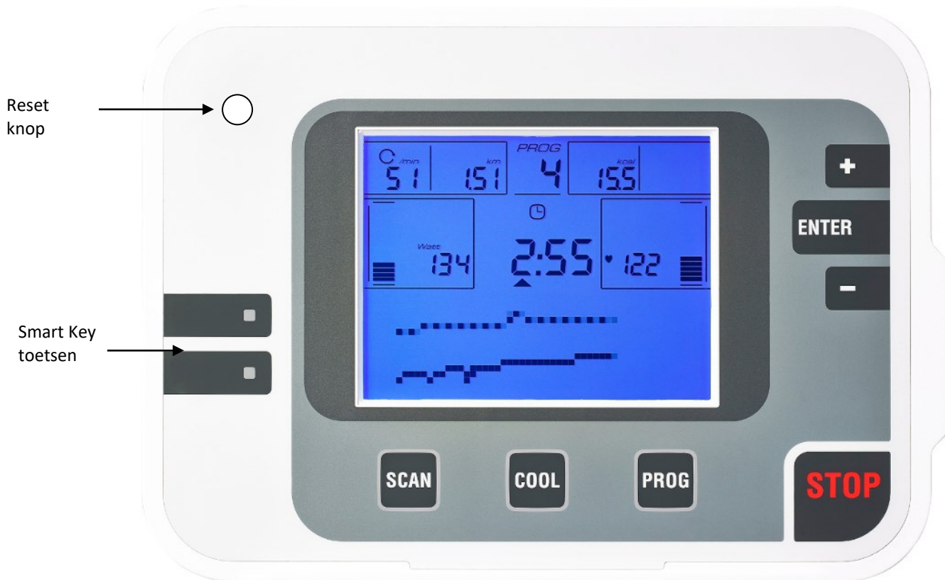
Figuur 2: Monitor vooraanzicht, met uitleg van de knopfuncties
