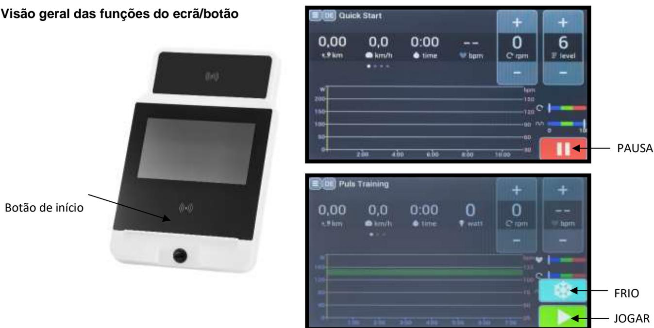
Fig. 9: Vista do monitor, para explicar as funções dos botões, a vista real pode variar em termos de cor, a atribuição dos botões é a mesma.
