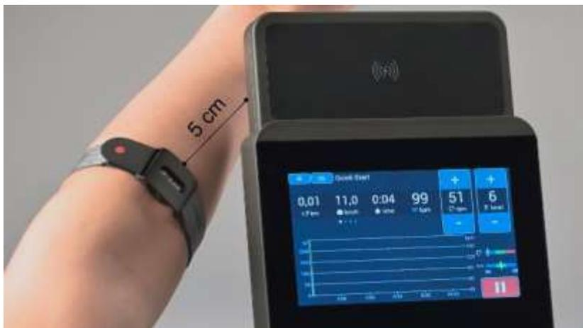
Fig. 11: Emparelhamento de um sensor ANT+ para transmissão do ritmo cardíaco
