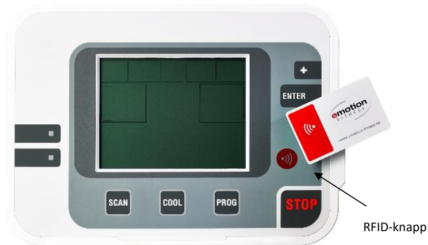
Fig.5: RFID-knapp, för RFID-detektering om mediet inte kan eller bör införas.
