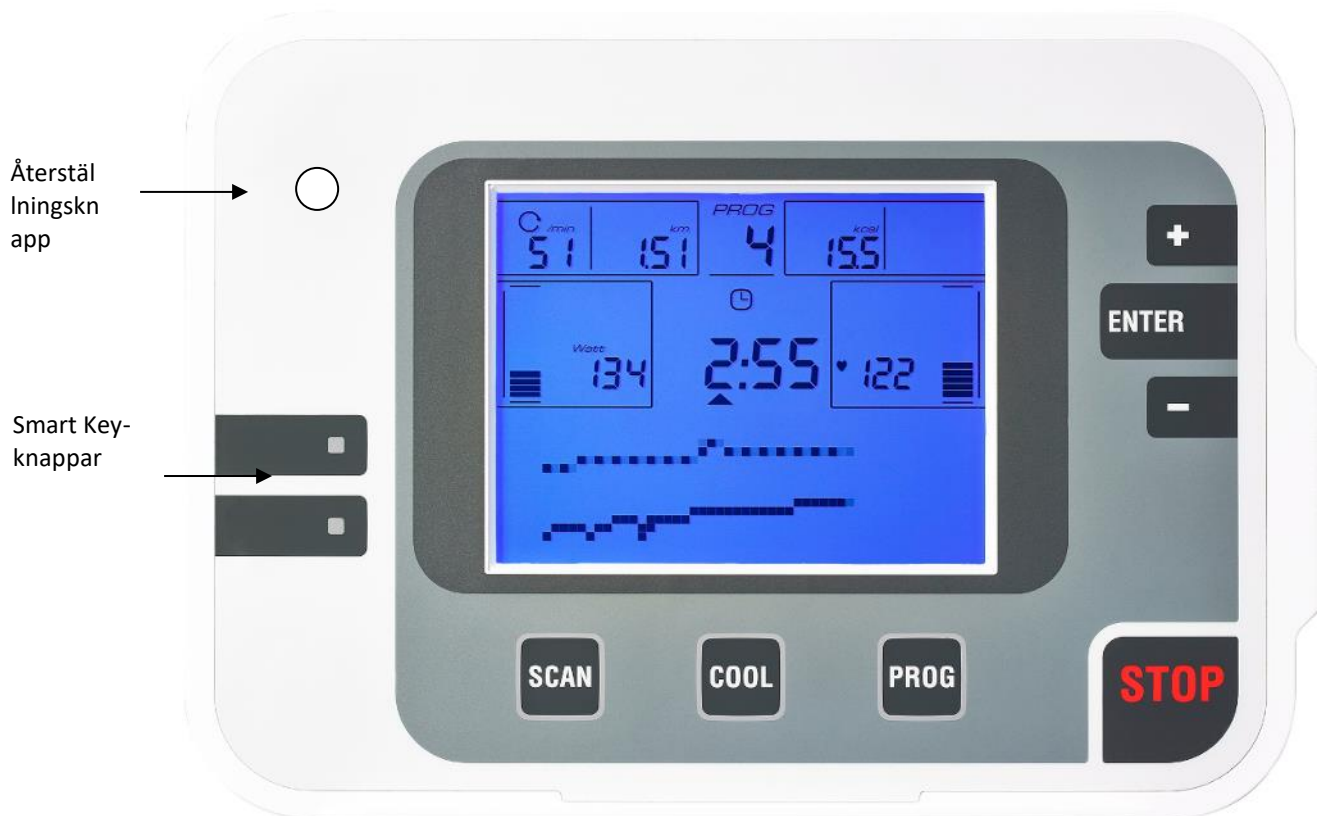
Figur 2: Bildskärmsvyn framifrån, med förklaring av knappfunktionerna.
