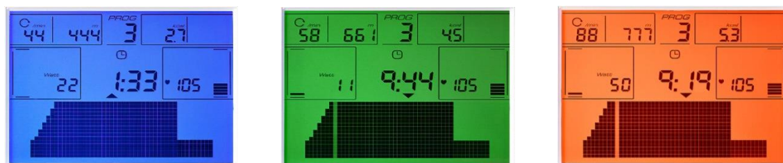
Fig.4: Flerfärgad bakgrundsbelysning som biofeedback för att indikera målpuffyllelse.
