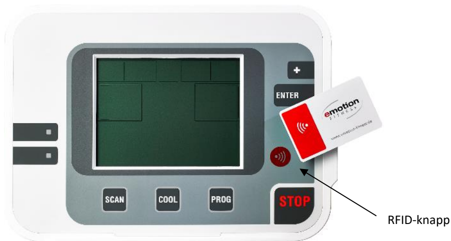
Fig.5: RFID-knapp, för RFID-detektering om ett medium inte kan eller bör införas.
