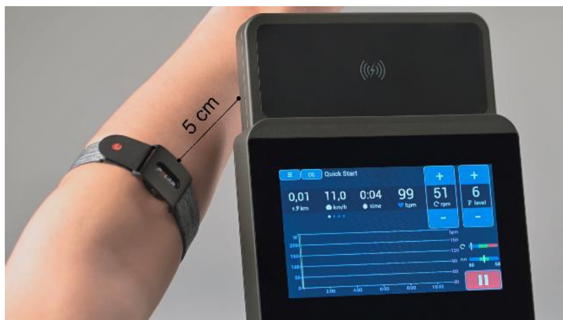
Obr.: Spárovanie snímača ANT+ na prenos srdcovej frekvencie
