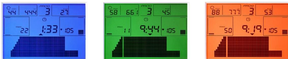
Fig.4: Retroiluminación multicolor como biofeedback para indicar el cumplimiento del objetivo.
