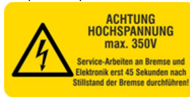
Fig.6: Aviso de advertencia en el freno por peligro de alta tensión.
