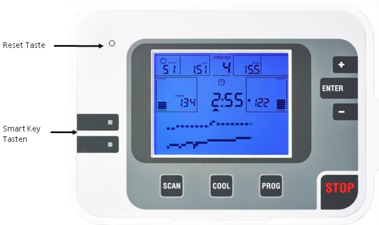
Figura 2: Vista frontal del monitor, explicando las funciones de los botones
