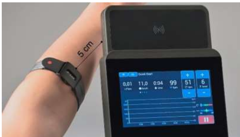
Fig. 11: Emparejamiento de un sensor ANT+ para la transmisión de la frecuencia cardíaca
