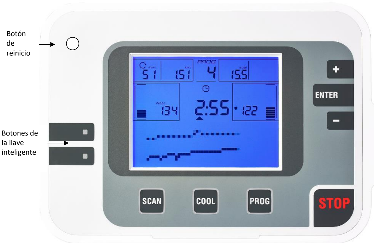
Figura 2: Vista frontal del monitor, explicando las funciones de los botones
