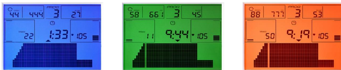
Fig.4: Retroiluminación multicolor como biofeedback para indicar el cumplimiento del objetivo.
