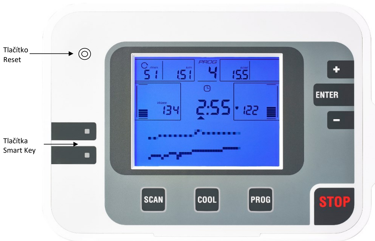
Obrázek 2: Čelní pohled na monitor, vysvětlení funkcí tlačítek
