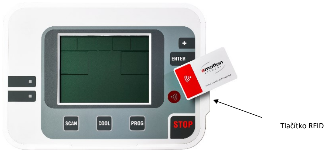
Obr.5: Tlačítko RFID pro detekci RFID v případě, že médium nelze nebo nemá být vloženo.
