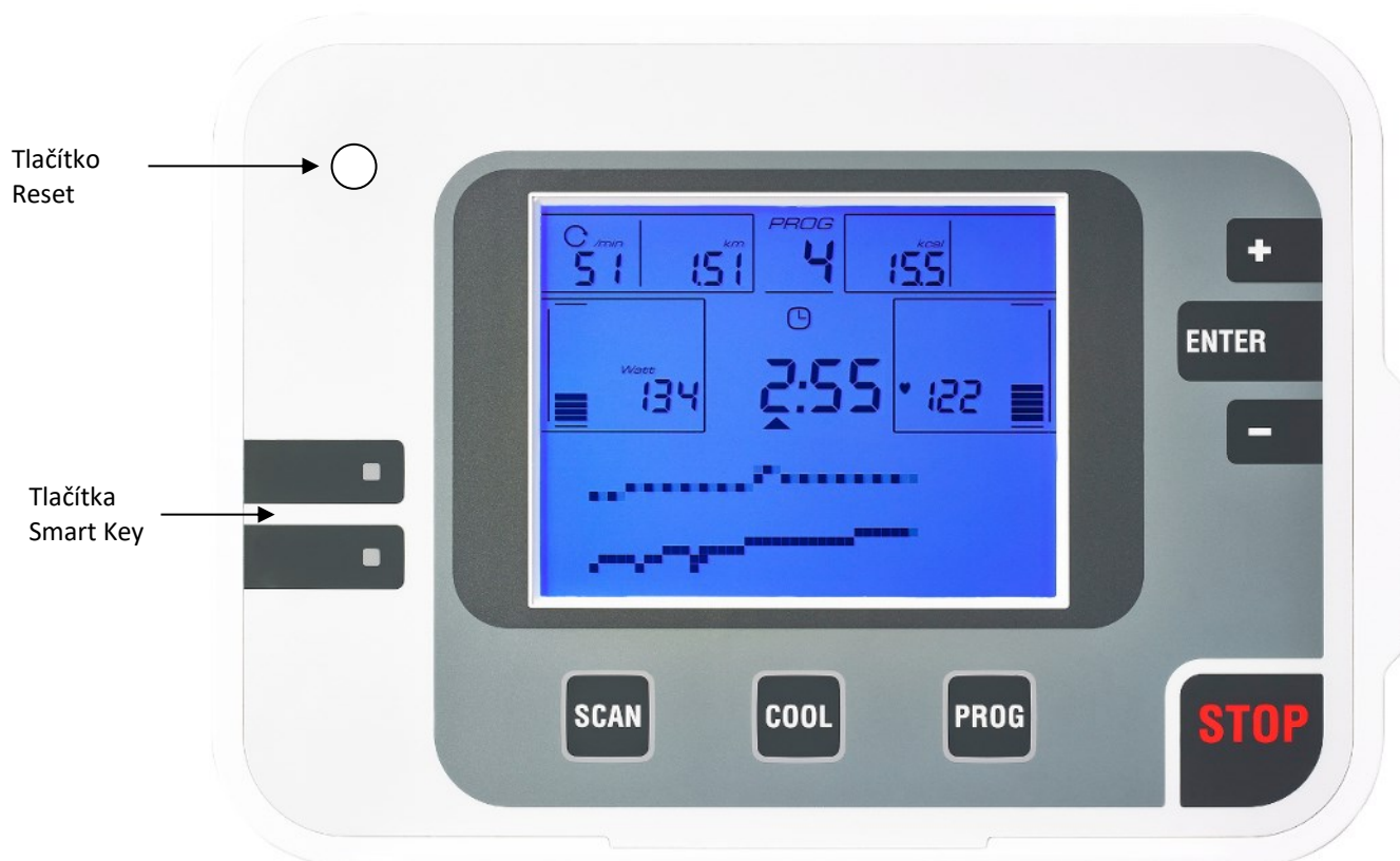
Obrázek 2: Čelní pohled na monitor, vysvětlení funkcí tlačítek
