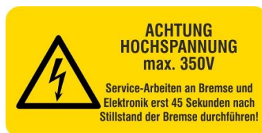
Obr.6: Výstražné upozornění na brzdě kvůli nebezpečí vysokého napětí.
