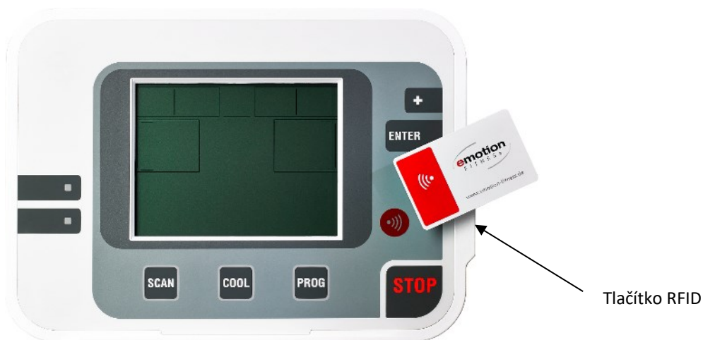
Obr.5: Tlačítko RFID pro detekci RFID, pokud médium nelze nebo nemá být vloženo.
