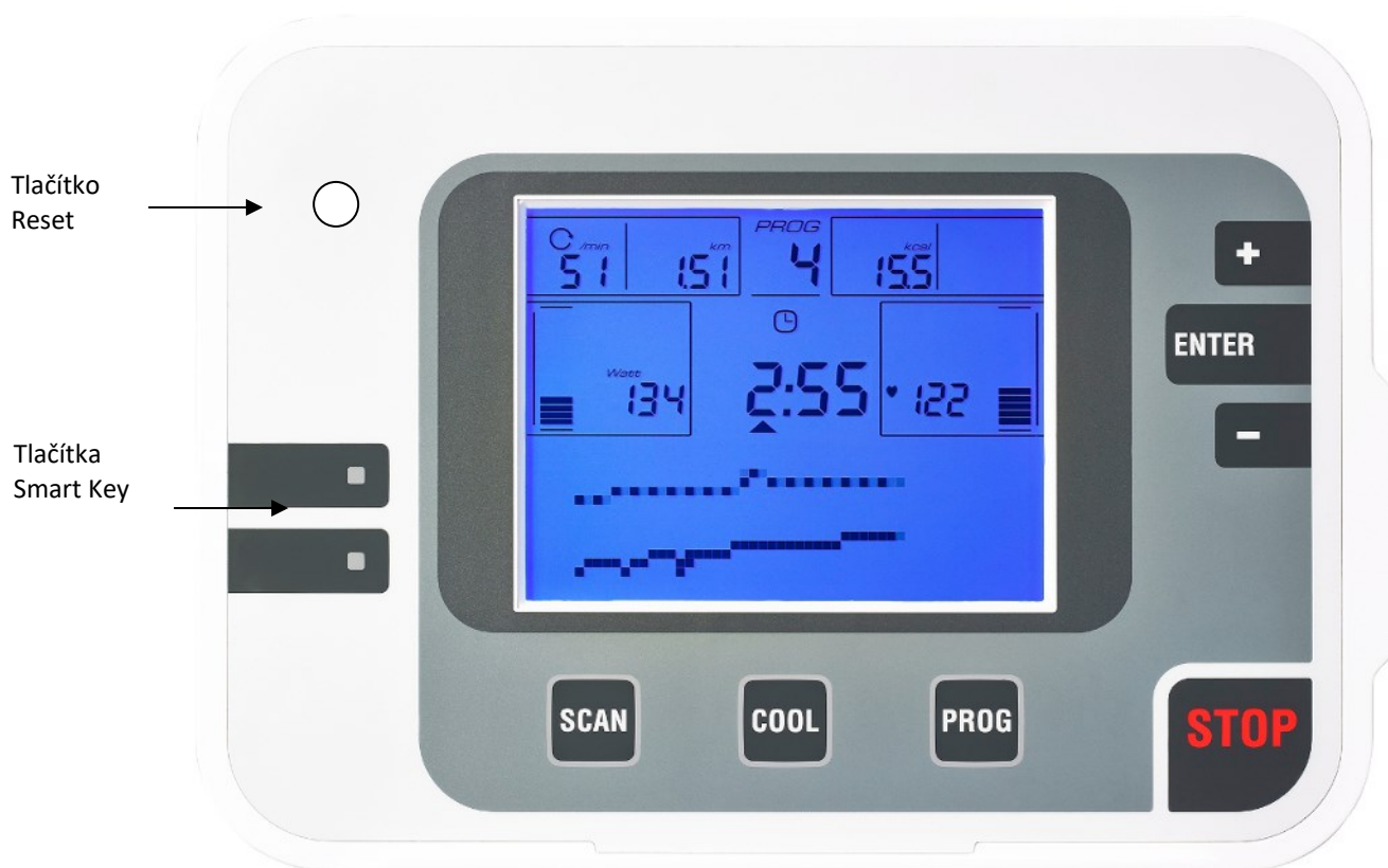
Obrázek 2: Čelní pohled na monitor, vysvětlení funkcí tlačítek
